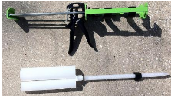
شکل ۸: تفنگ مخصوص تزریق اپوکسی
