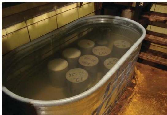
شکل ۱: عمل آوری نمونه‌ها به مدت ۲۸ روز در آب
