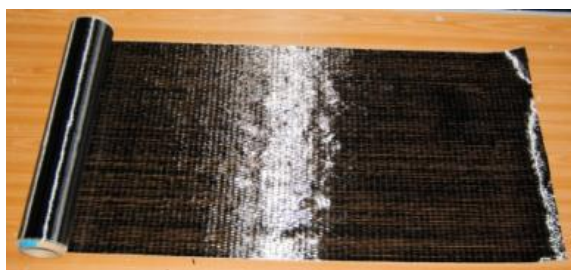
شکل ۷: الیاف کربن مورد استفاده در این تحقیق
