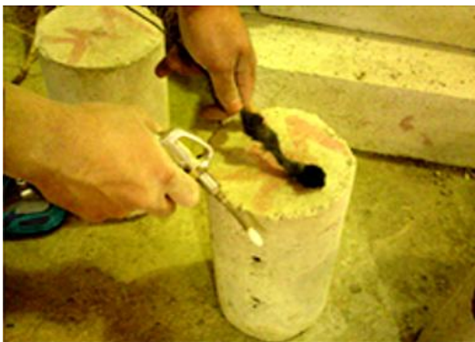
شکل ۵: تمیز کردن سوراخ توسط پمپ باد
