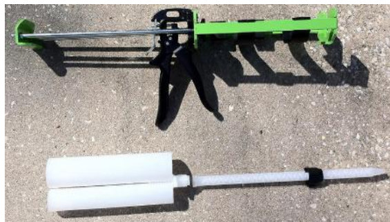
شکل ۸: تفنگ مخصوص تزریق اپوکسی
