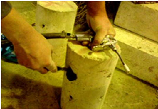
شکل ۴: تمیز کردن سوراخ توسط برس
