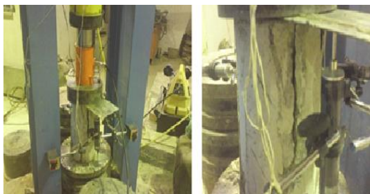
شکل ۹: انجام تست فشار روی نمونه‌ها
