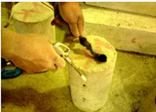
شکل ۵: تمیز کردن سوراخ توسط پمپ باد
