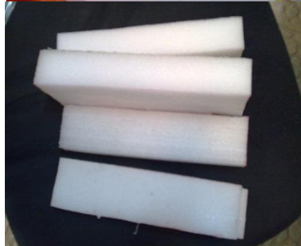
شکل ۲۱: فوم پلی اتیلن و ژئوگرید مدل به کار رفته در آزمایش‌ها
