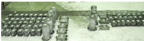
شکل ۲: ساخت انواع نمونه‌های مکعبی، منشوری و استوانه‌ای
