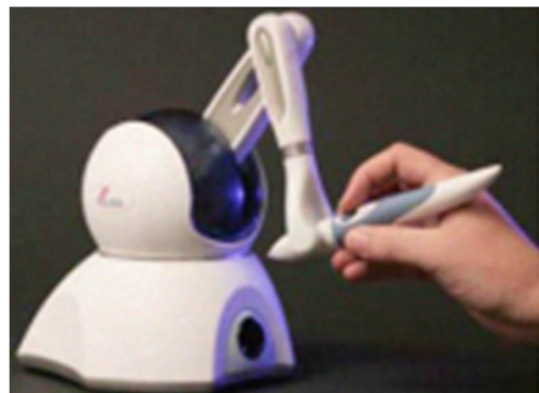
شکل 1- ربات (واسط) هپتیک فنتوم به عنوان یک نمونه از واسط‌های نیرویی-حرکتی بین انسان و محیط مجازی در رایانه
