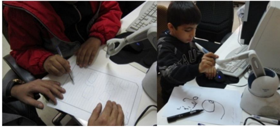
شکل 8- تصویر دو دانش آموز نابینا در حال استفاده از ربات فنتوم و ترسیم اشکال
